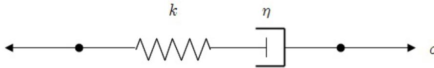
Figure: 점탄성 모델: Maxwell 모델
